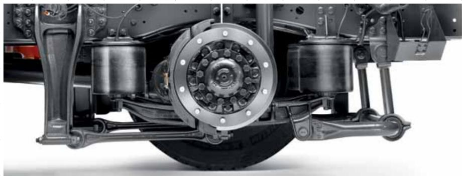
Огромный выбор **передаточных чисел ведущих мостов** (от 2.64 до 6.17) позволяет подобрать оптимальный вариант для конкретного типа работ: длинные передаточные числа отлично подойдут для езды по шоссе, в то время как короткие передаточные отношения - идеальный вариант для сложных задач, где необходима максимальная тяга (например, при эксплуатации на горных дорогах).
