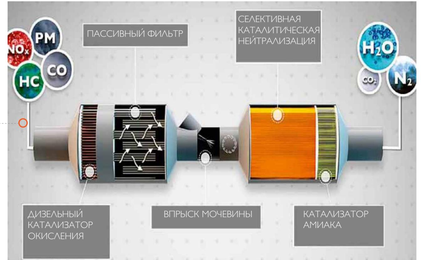
ТЕРМОДИНАМИЧЕСКАЯ ЭФФЕКТИВНОСТЬ ДВИГАТЕЛЕЙ CURSOR ДЛЯ НОВОГО STRALIS БЫЛА ОПТИМИЗИРОВАНА: БОЛЕЕ ВЫСОКАЯ ТЕМПЕРАТУРА СГОРАНИЯ **СНИЖАЕТ РАСХОД ТОПЛИВА** И ОБРАЗОВАНИЕ ТВЕРДЫХ ЧАСТИЦ. БЛАГОДАРЯ КРАЙНЕ ВЫСОКОЙ ЭФФЕКТИВНОСТИ СИСТЕМЫ HI-eSCR (> 95% ПО СРАВНЕНИЮ С 80-85% У БЛИЖАЙШИХ КОНКУРЕНТОВ) СОДЕРЖАНИЕ ОКСИДОВ АЗОТА СООТВЕТСТВУЕТ ТРЕБОВАНИЯМ ЕВРО-6 БЕЗ ПРИМЕНЕНИЯ EGR.
