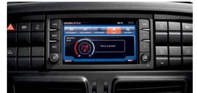
**DRIVER ATTENTION SUPPORT:** ДАННАЯ СИСТЕМА ПОСТОЯННО КОНТРОЛИРУЕТ УРОВЕНЬ ВНИМАНИЯ ВОДИТЕЛЯ, АНАЛИЗИРУЯ ПЕРЕМЕЩЕНИЯ РУЛЕВОГО КОЛЕСА, БЛАГОДАРЯ ЧЕМУ ПРЕДОТВРАЩАЮТСЯ ПОТЕРЯ ВНИМАНИЯ И ЗАСЫПАНИЕ ВОДИТЕЛЯ. ЕСЛИ СИСТЕМА РАСПОЗНАЕТ, ЧТО ВОДИТЕЛЬ ЗАСЫПАЕТ, ТО ОНА ПРЕДУПРЕДИТ ЕГО О НЕОБХОДИМОСТИ ОСТАНОВИТЬСЯ НА ОТДЫХ С ПОМОЩЬЮ СПЕЦИАЛЬНОГО СООБЩЕНИЯ НА ДИСПЛЕЙ И ГРОМКОГО ЗВУКОВОГО СИГНАЛА.
