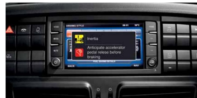
ПРИ РАБОТАЮЩЕМ ДВИГАТЕЛЕ НА ЭКРАНЕ IVECONNECT ОТОБРАЖАЮТСЯ **РЕКОМЕНДАЦИИ ПО ЭКОНОМИИ ТОПЛИВА** (ИСПОЛЬЗОВАНИЕ ПЕРЕДАЧ, ТОРМОЗОВ, МОТОРНОГО ТОРМОЗА, УСКОРЕНИЯ И ИНЕРЦИИ).
