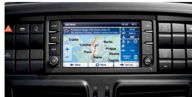
**СПУТНИКОВАЯ НАВИГАЦИЯ С ФУНКЦИЕЙ НАВИГАЦИИ ДЛЯ ГРУЗОВИКА:** РАССЧИТЫВАЕТ ОПТИМАЛЬНЫЙ МАРШРУТ С УЧЕТОМ МАССЫ И ГАБАРИТОВ АВТОМОБИЛЯ (УКАЗЫВАЮТСЯ ВОДИТЕЛЕМ). В СИСТЕМУ ВСТРОЕНЫ СЛЕДУЮЩИЕ ФУНКЦИИ:
