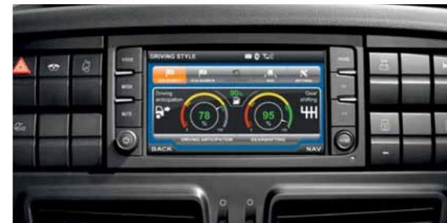
**DRIVING STYLE EVALUATION:** ДАННАЯ СИСТЕМА ПО СЛОЖНОМУ АЛГОРИТМУ (РАЗРАБОТАН КОМПАНИЕЙ IVECO) ОБРАБАТЫВАЕТ ДАННЫЕ, ПОЛУЧЕННЫЕ ОТ ДВИГАТЕЛЯ, АВТОМОБИЛЯ И GPS-НАВИГАЦИИ, И ОЦЕНИВАЕТ СТИЛЬ ВОЖДЕНИЯ С ТОЧКИ ЗРЕНИЯ ЭКОНОМИИ ТОПЛИВА. ОЦЕНКА ВЫПОЛНЯЕТСЯ НА ОСНОВЕ НЕСКОЛЬКИХ ПОКАЗАТЕЛЕЙ, СГРУППИРОВАННЫХ В ТРЕХУРОВНЕВУЮ ИЕРАРХИЧЕСКУЮ СТРУКТУРУ, В КОТОРОЙ УЧИТЫВАЕТСЯ СЛОЖНОСТЬ ПОСТАВЛЕННОЙ ЗАДАЧИ.
